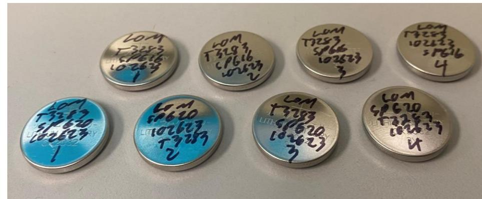
Les deux SPG16 et SPG20 se comportent bien par rapport au matériau de référence en graphite commercial pour les capacités de charge et de décharge, l'efficacité coulombienne de la perte au premier cycle et la capacité gravimétrique. Avec ces résultats de performance électrochimique produits par Polaris
